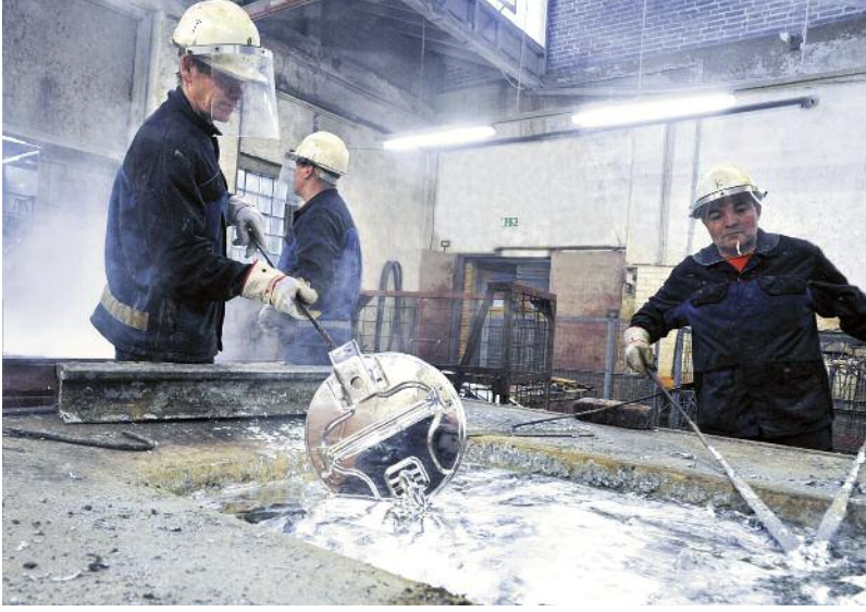
Manuell wird das Verzinkungsgut vorsichtig eingelassen, gedreht und gewendet
