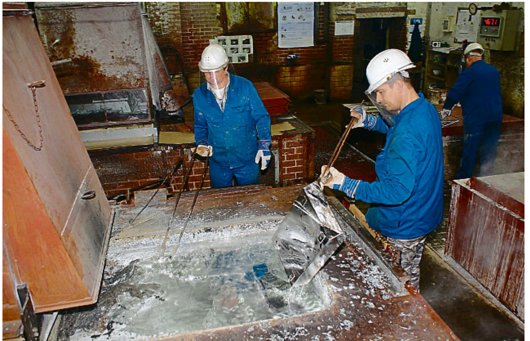
Von Hand wird das Metallteil im kleinen Becken mit speziellen Zangen angepackt und mit Zink überzogen.
