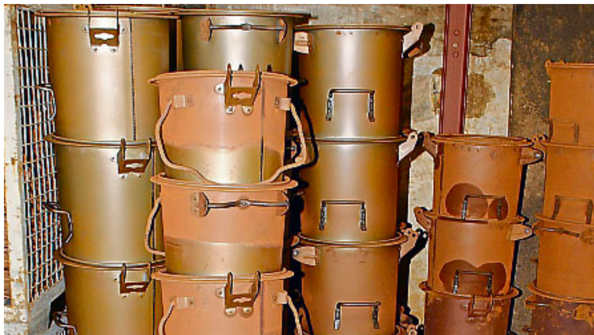
Behälter wie diese warten bei Renner auf das heiße Bad. Danach sind sie dauerhaft geschützt.
